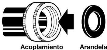
**IMPORTANTE:** Para evitar que haya fugas, verifique que las mangueras de entrada de agua tengan arandelas planas en ambos extremos. La máquina debe estar conectada a los grifos de agua con mangueras de entrada nuevas y arandelas planas (no provistas). No use mangueras viejas. No use las mangueras sin las arandelas.
