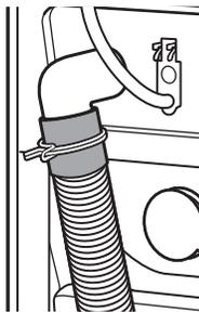
4. El sistema de desagote de la lavadora se puede instalar utilizando un desagote de piso, un tubo vertical de pared, un tubo vertical de piso o una tina de lavadero.
