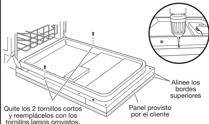
Con un destornillador Torx® T15® instale los dos tornillos largos #8 x 1<sup>3</sup>/<sub>8</sub>" en las esquinas superiores para asegurar el panel de madera a la medida en su lugar.
