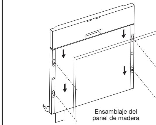
Alinee los taquitos en el panel de madera a la medida a las ranuras en forma de bocallave ubicadas en el ensamblaje de la puerta. Asegúrese de que los 4 taquitos de plástico estén adentro de las ranuras en forma de bocallave. Deslice el panel de madera hacia abajo hasta que la superficie de arriba del panel de madera esté alineada con la parte de arriba de la puerta.
