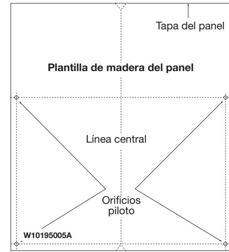
Sujete la plantilla provista a la parte de atrás del panel a la medida utilizando cinta adhesiva. Asegúrese de que el centro de la plantilla esté alineado con el centro del panel de madera y que la parte de arriba de la plantilla esté alineada con la cara superior del panel de madera.
