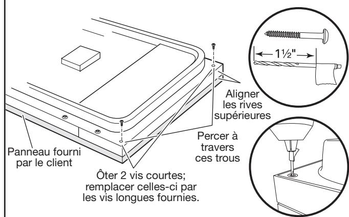
Ouvrir la porte et aligner les rives supérieures. Prépercer deux avant-trous avec un foret de  $\frac{3}{32}$ ". Utiliser du ruban adhésif pour marquer sur le foret la profondeur à ne pas dépasser pour les trous. Percer les avant-trous à une profondeur d'environ  $1\frac{1}{2}$ " (38 mm) dans les angles supérieurs de la porte (utiliser comme guide le trou dans la doublure de la porte).
