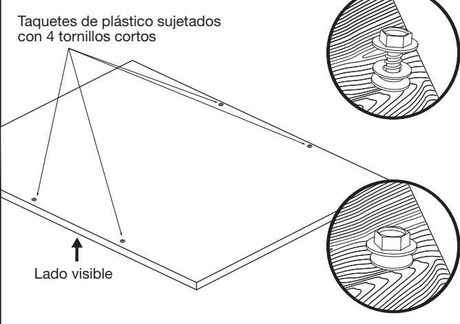
Fije los 4 pernos de plástico al panel de madera utilizando los 4 tornillos cortos de cabeza hexagonal  $\frac{5}{16}$ " provistos.
