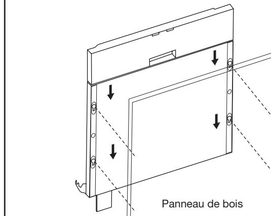
Aligner les goujons de plastique (sur le panneau de bois personnalisé) avec les trous en forme de trou de serrure (sur la porte). Veiller à bien engager les 4 goujons de plastique dans les trous allongés (forme de trou de serrure). Laisser glisser le panneau de bois vers le bas pour placer la rive supérieure du panneau de bois en affleurement avec le sommet de la porte.
