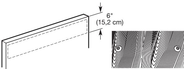
Instale la(s) manija(s) a la medida en la parte frontal del panel de madera, dentro de la línea punteada.
