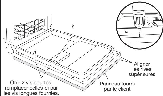
À l'aide d'un tournevis Torx® T15®, installer deux vis n° 8 x 1 $\frac{3}{8}$ " dans les angles supérieurs pour fixer le panneau de bois personnalisé en place.
