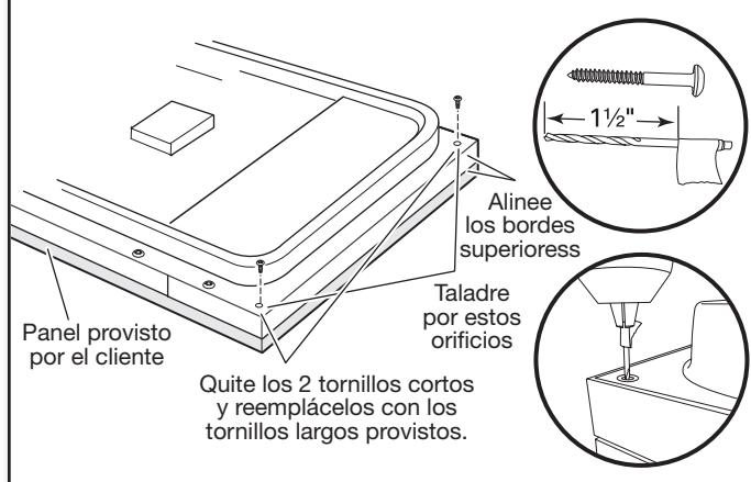
Abra la puerta y alinee los bordes superiores. Use cinta adhesiva para marcar la broca de  $\frac{3}{32}$ " y así medir la profundidad del orificio de aproximadamente  $1\frac{1}{2}$ " (38 mm). Taladre orificios piloto en las esquinas superiores de la puerta usando el orificio en el revestimiento como guía.
