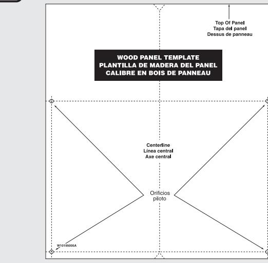
Sujete la plantilla provista a la parte de atrás del panel a la medida utilizando cinta adhesiva. Asegúrese de que el centro de la plantilla esté alineado con el centro del panel de madera y que la parte de arriba de la plantilla esté alineada con la cara superior del panel de madera.
