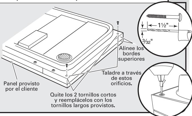
Abra la puerta y alinee los bordes superiores. Use cinta adhesiva para marcar la broca de  $\frac{9}{32}$ " en y así medir la profundidad del orificio de aproximadamente  $1\frac{1}{2}$ " (3.8 cm). Taladre orificios piloto en las esquinas superiores de la puerta usando el orificio en el revestimiento como guía.
