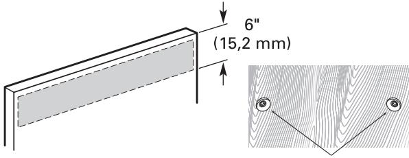
Instale la(s) manija(s) a la medida en la parte frontal del panel de madera, dentro de la línea punteada.
