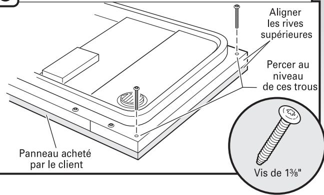
À l'aide d'un tournevis Torx® T15®, installer deux vis n° 8 x 1 $\frac{3}{8}$ " dans les angles supérieurs pour fixer le panneau de bois personnalisé en place.
