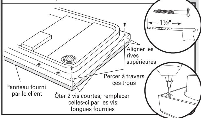
Ouvrir la porte et aligner les rives supérieures. Pré-percer deux avant-trous avec un foret de  $\frac{3}{32}$ ". Utiliser du ruban adhésif pour marquer sur le foret la profondeur à ne pas dépasser pour les trous. Percer les avant-trous à une profondeur d'environ  $1\frac{1}{2}$ " (3,8 cm) dans les angles supérieurs de la porte (utiliser comme guide le trou dans la doublure de la porte).
