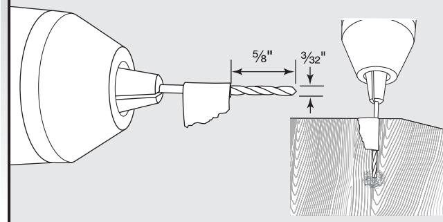
**NOTA:** No taladre a una profundidad mayor de  $\frac{5}{8}$ " (16 mm) para evitar taladrar a través del panel. Las profundidades de los orificios piloto provistas son para un panel de  $\frac{3}{4}$ " (19 mm) de grosor.
