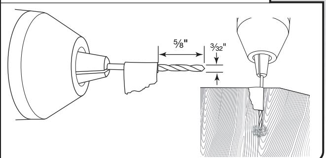
**REMARQUE :** Veiller à ne pas traverser le panneau – la profondeur des trous ne doit pas dépasser  $\frac{5}{8}$ " (16 mm). La profondeur indiquée pour les avant-trous correspond à un panneau d'épaisseur  $\frac{3}{4}$ " (19 mm).
