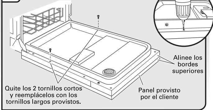
Quite los tornillos cortos (los terceros desde la parte superior) que están a cada lado del panel interior de la puerta. Use cinta adhesiva para marcar la broca de  $\frac{3}{32}$ " y así medir la profundidad del orificio de aproximadamente 1 1/2" (3.8 cm). Taladre 2 orificios piloto, usando el orificio del revestimiento de la puerta como guía dentro del panel. Instale los dos tornillos largos restantes.
