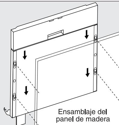
Alinee los taquetes en el panel de madera a la medida a las ranuras en forma de bocallave ubicadas en el ensamblaje de la puerta. Asegúrese de que los 4 taquetes de plástico estén adentro de las ranuras en forma de bocallave. Deslice el panel de madera hacia abajo hasta que la superficie de arriba del panel de madera esté alineada con la parte de arriba de la puerta.
