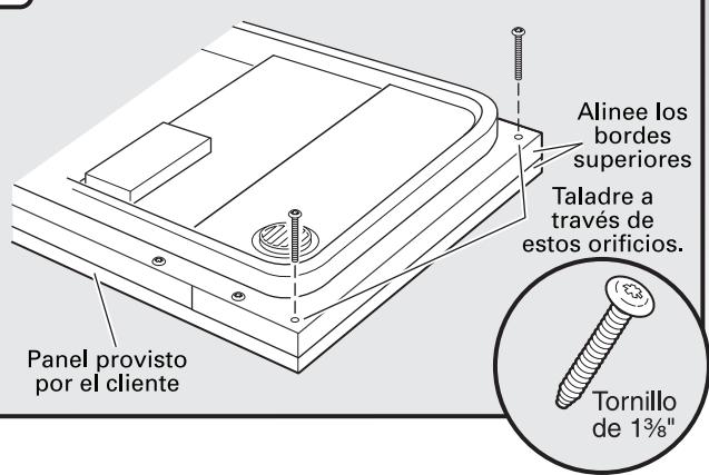
Con un destornillador Torx® T15® instale los dos tornillos largos #8 x 1 3/8" en las esquinas superiores para asegurar el panel de madera a la medida en su lugar.
