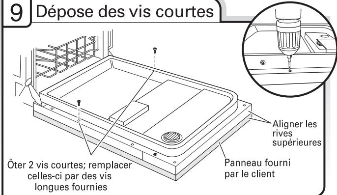
Retirer les vis courtes (troisièmes à partir du sommet) de chaque côté du panneau de porte intérieur. Pré-percer 2 avant-trous en utilisant un foret de  $\frac{3}{32}$ ". Utiliser du ruban adhésif pour marquer le foret et calibrer la profondeur des trous. Percer des avant-trous d'environ 1 $\frac{1}{2}$ " (3,8 cm) dans le panneau en utilisant le trou de la doublure de la porte comme guide. Installer les 2 vis longues restantes.
