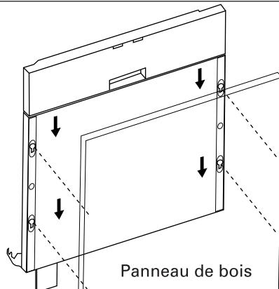
Aligner les goujons de plastique (sur le panneau de bois personnalisé) avec les trous en forme de trou de serrure (sur la porte). Veiller à bien engager les 4 goujons de plastique dans les trous allongés (forme de trou de serrure). Laisser glisser le panneau de bois vers le bas pour placer la rive supérieure du panneau de bois en affleurement avec le sommet de la porte.
