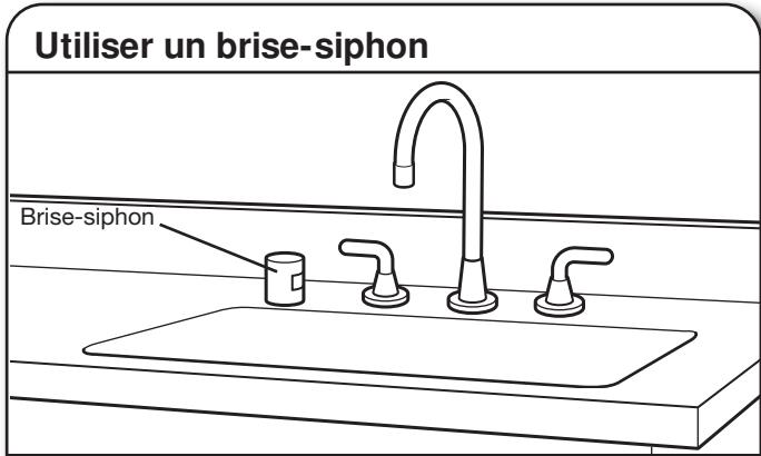
Si nécessaire, le dispositif de brise-siphon doit être installé conformément aux instructions d'installation de ce dernier. Lors du raccordement du dispositif de brise-siphon à la canalisation d'égout en T ou au raccord de broyeur à déchets, un tuyau en caoutchouc (non fourni) sera nécessaire. Utiliser des raccords de canalisation d'évacuation de diamètre intérieur de 1/2 po (13 mm) minimum.
