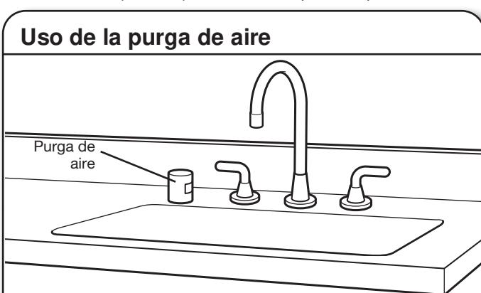
Si se requiere, la purga de aire se debe instalar siguiendo las instrucciones de instalación de la misma. Al conectar la purga de aire, se requiere una manguera de goma (no proporcionada) para conectarla al tubo de residuos en "T" o la entrada del colector de residuos.
