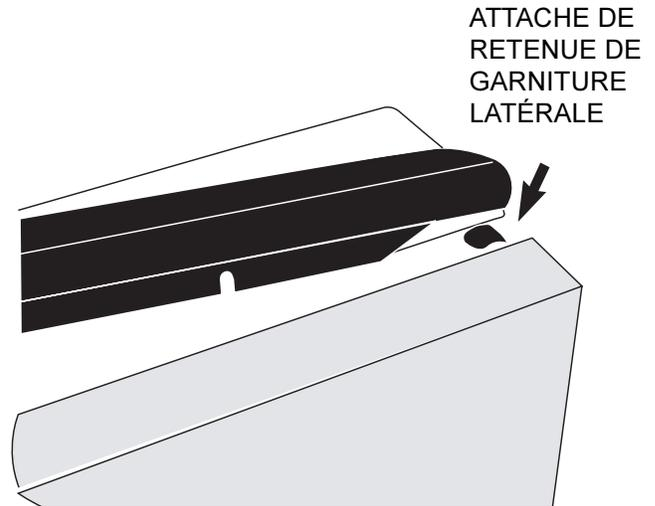
6. Veiller à ce que les rainures de garniture de blocage supérieures s'engagent dans les rivets du panneau de porte, tout en s'installant simultanément dans la rainure du panneau décoratif.
