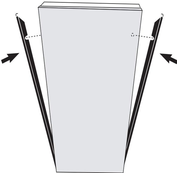
5. Aligner la garniture de blocage supérieure sur les attaches situées sur le dessus de la garniture latérale.
