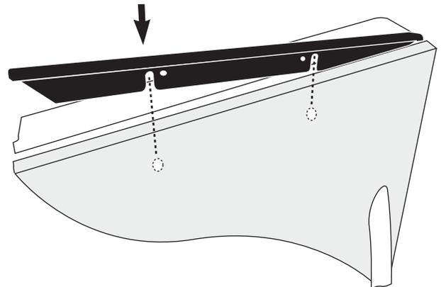
8. La garniture supérieure complètement engagée doit complètement recouvrir les attaches de la garniture latérale et être pratiquement en affleurement avec la partie supérieure de la porte.
