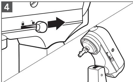
**Levante a cabeça do motor:** Destrave e levante a cabeça do motor. Em seguida, trave a cabeça para mantê-la levantada.
