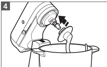
Acople o gancho para massa da sua receita, usando as instruções no manual de Instruções da batedeira Stand Mixer. Em seguida, coloque a cabeça do motor novamente na posição para baixo e trave-a no lugar.
