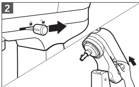
Destroce e levante a cabeça do motor. Em seguida, trave a cabeça para mantê-la levantada.
