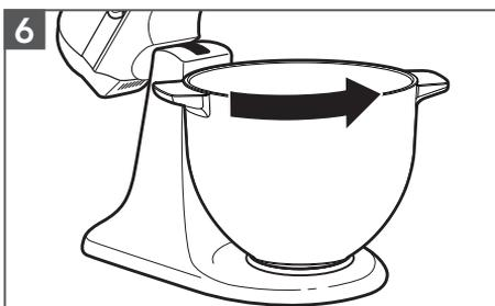
**Remove a tigela de pão:** Gire para destravar a tigela de pão da placa de fixação.
