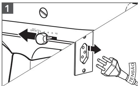
Desconecte a batedeira Stand Mixer pressionando OFF (desligar) (0) e retire o plugue da tomada.
