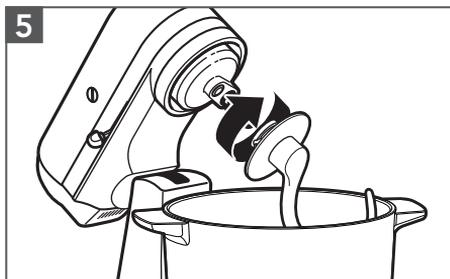
**Remove o acessório:** Pressione o acessório para cima, gire-o e afaste-o do eixo do batedor.
