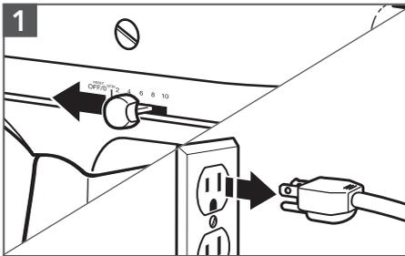
1 Déplacer le bouton d'alimentation sur OFF (arrêt) (0), puis débrancher le batteur sur socle.
