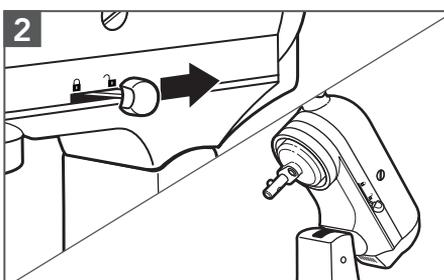
**Levante la cabeza del motor:** Desbloquee y levante la cabeza del motor. Luego, bloquee\* la cabeza del motor para mantenerla levantada.
