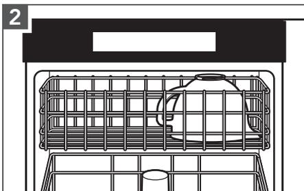
Le bol en céramique doit être placé à l'envers dans le cas d'un lavage au lave-vaisselle.
