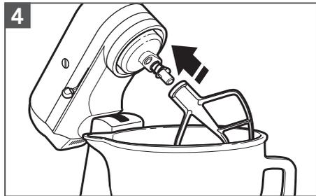
4 Fixer l'accessoire adapté à votre recette en suivant les instructions figurant dans le guide d'instructions du batteur sur socle. Rabattre ensuite la tête du moteur et verrouiller en place.
