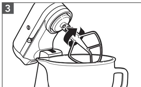
**Retire el accesorio:** Presione el accesorio hacia arriba, gírelo y sáquelo del eje del batidor.
