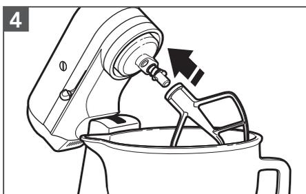
Coloque el accesorio adecuado para su receta, siguiendo las indicaciones del Manual de instrucciones de la batidora con base. Luego vuelva a colocar la cabeza del motor en la posición inferior y trábela en su lugar.
