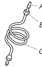
A. Manguito de compresión C. Tubería de cobre B. Tuerca de compresión
