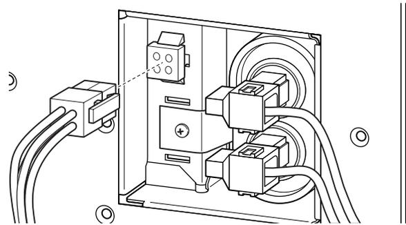
8. Remplacer le cache-borne électrique du ventilateur.
