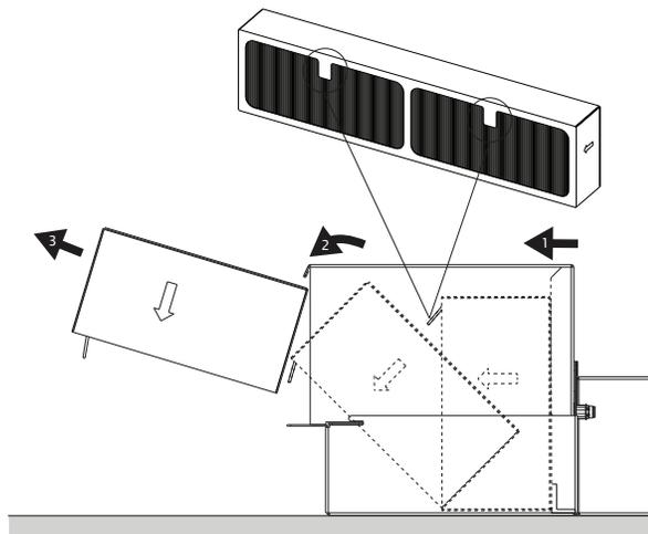
4. Nettoyer à fond et sécher le logement du filtre. Le logement peut être nettoyé avec un essuie-tout en papier et un nettoyant ménager ou un chiffon et de l'eau savonneuse tiède. Aucun nettoyant particulier n'est préconisé.
