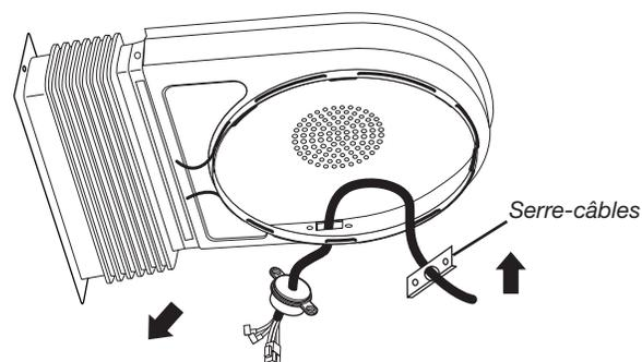
3. Passer le câble du moteur de ventilateur dans l'ouverture et placer la bride du serre-câbles à l'intérieur du couvercle du ventilateur. Mettre en place et serrer les deux (2) vis #8-18 x 3/8" comprises pour fixer la bride du serre-câbles.
