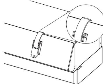
8. Replacer le panneau d'accès avant inférieur en alignant les goujons avec les fentes en forme de trou de serrure de la cuisinière. Pousser le panneau d'accès vers l'avant sur les fentes, puis vers le bas pour fixer le tout.
