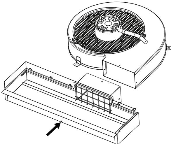
2. Fixer la partie inférieure du boîtier de filtre au moteur du ventilateur à l'aide des trois (3) vis #8 - 3/8" fournis. Assurer l'étanchéité des jointures avec du ruban aluminium.
