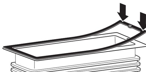
6. Poser le couvercle sur le ventilateur. Écarter légèrement le ressort de retenue du couvercle afin de permettre à ce dernier de se positionner sur le ventilateur. Vous assurer que l'anneau de retenue du couvercle du ventilateur est maintenu sécuritairement en place.
