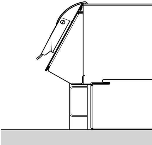
**REMARQUE :** Le ventilateur pourrait avoir besoin de cales si l'avant de la partie inférieure du boîtier de filtre est sous le cadre avant inférieur du support transversal.
