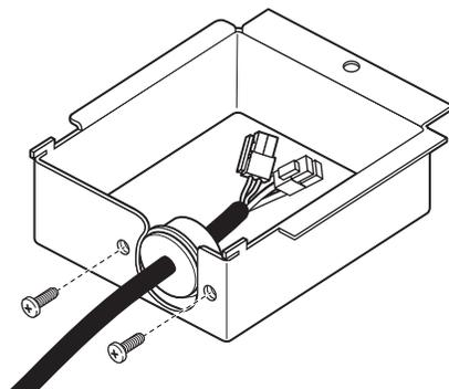
6. Repérer le connecteur à deux broches situé sur la borne du câble du moteur de ventilateur et le brancher au connecteur à deux broches du condensateur.
