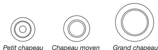
Un chapeau de brûleur correctement placé doit être horizontal. Si les chapeaux de brûleur ne sont pas correctement installés, les brûleurs de surface ne s'allumeront pas. Lorsque le chapeau de brûleur est correctement aligné, il ne balance pas et n'oscille pas.
