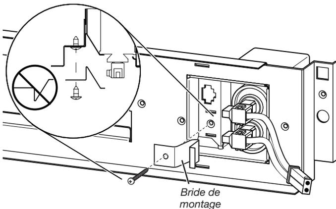
5. Fixer le serre-câbles du moteur de ventilateur, près du bout du raccord rapide, au couvercle du cache-borne électrique du ventilateur à l'aide des deux vis comprises.
