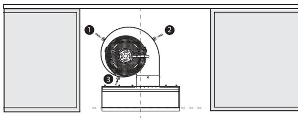
**REMARQUE :** Si l'ajustement de hauteur est trop important, l'installation du ventilateur pourrait nécessiter des cales.
