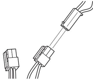
7. Repérer le connecteur à 4 broches sur le fil du ventilateur et la brancher au point de raccordement se trouvant directement à l'arrière du plateau de rangement du condensateur.
