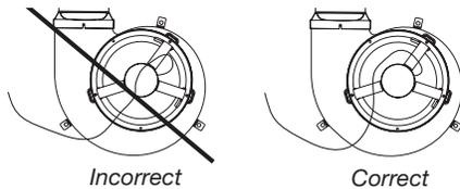
7. Tourner le couvercle du ventilateur afin que les soufflets soient positionnés vers la droite de l'installation et pour que ses rebords fassent face au sol comme illustré.
