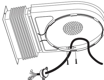
4. Repositionner la bague de retenue du couvercle du ventilateur de la façon illustrée.
