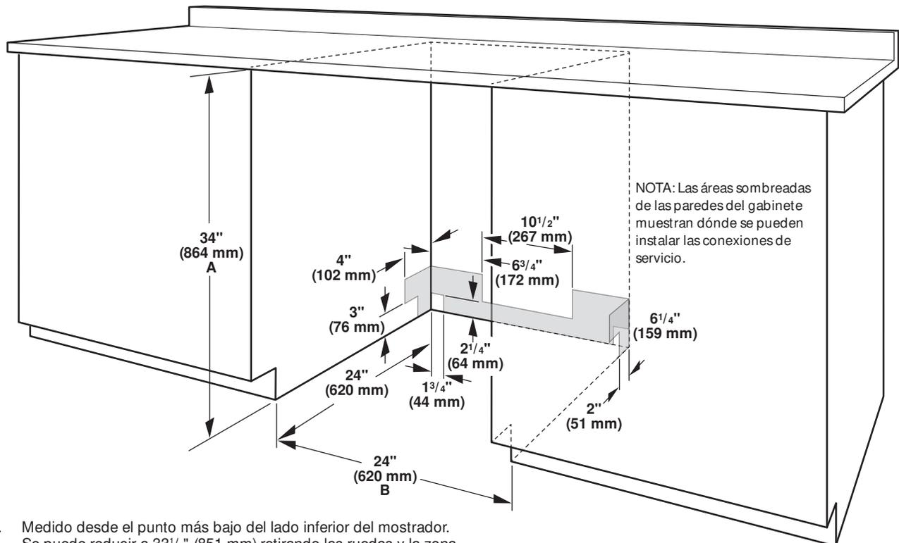
NOTA: Las áreas sombreadas de las paredes del gabinete muestran dónde se pueden instalar las conexiones de servicio.
