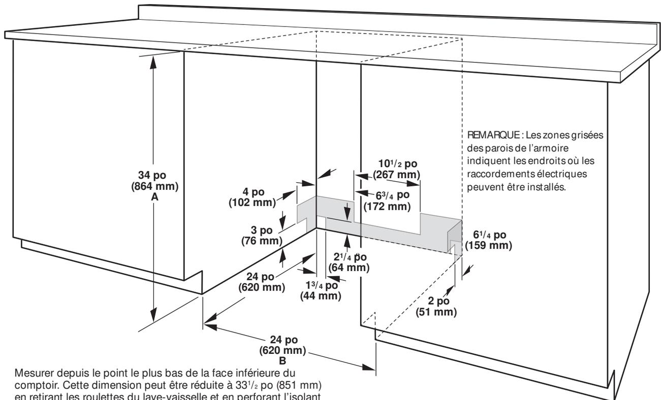
REMARQUE : Les zones grisées des parois de l'armoire indiquent les endroits où les raccordements électriques peuvent être installés.
