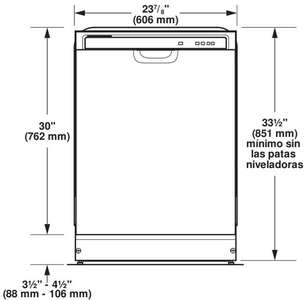
Para un zoclo de 100 mm (4"), la altura de la abertura del gabinete es de 863 mm (34 1/2").
