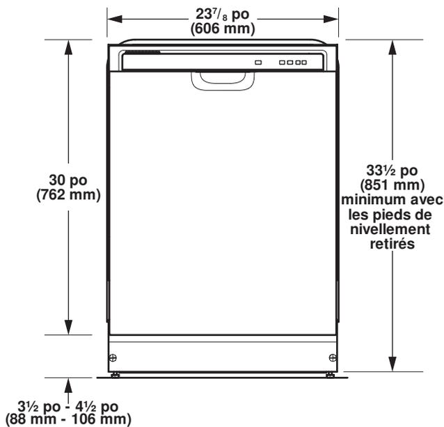
Pour un coup-de-pied de 4 po (100 mm), la hauteur de l'ouverture est de 34 <sup>1</sup>/<sub>2</sub> po (863 mm).
