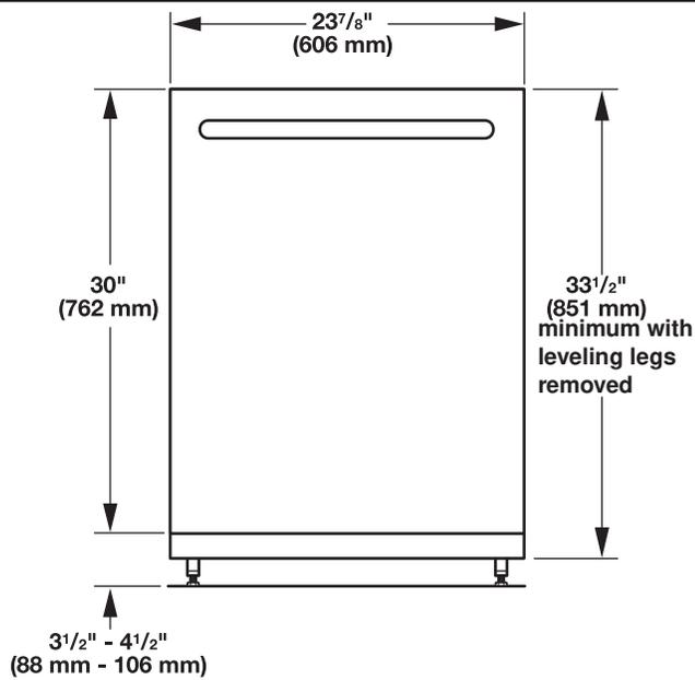
Para un zoclo de 100 mm (4"), la altura de la abertura del gabinete es de 863 mm (34<sup>1</sup>/<sub>2</sub>").
