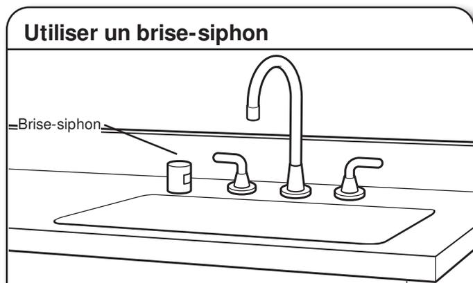
Si nécessaire, le dispositif de brise-siphon doit être installé conformément aux instructions d'installation de ce dernier. Lors du raccordement du dispositif de brise-siphon à la canalisation d'égout en T ou au raccord de broyeur à déchets, un tuyau en caoutchouc (non fourni) sera nécessaire.
