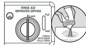
Vuelva a colocar la tapa del depósito y gírela hasta "Lock" (Bloquear). Asegúrese de que la tapa esté completamente bloqueada.
