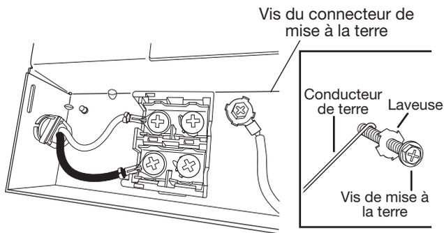
Passer le cordon d'alimentation dans le serre-câbles situé à l'arrière du boîtier de raccordement. Retirer la vis de liaison à la terre du plancher surélevé à l'intérieur du boîtier et la placer à travers la borne en anneau de la vis verte de mise à la terre du cordon d'alimentation. Si le fil ne comporte pas de borne en anneau, plier une boucle au bout du fil. Rattacher et serrer la vis de liaison à la terre sur le plancher surélevé du boîtier.
