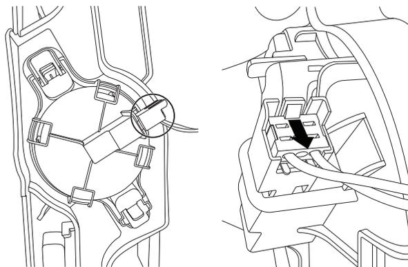
Vérifier l'absence de tout contact entre le conducteur ou le cordon d'alimentation et le moteur du lave-vaisselle ou la partie inférieure de la cuve du lave-vaisselle.
