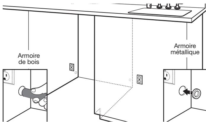
**Armoire de bois :** Poncer l'orifice jusqu'à obtenir une surface lisse.
