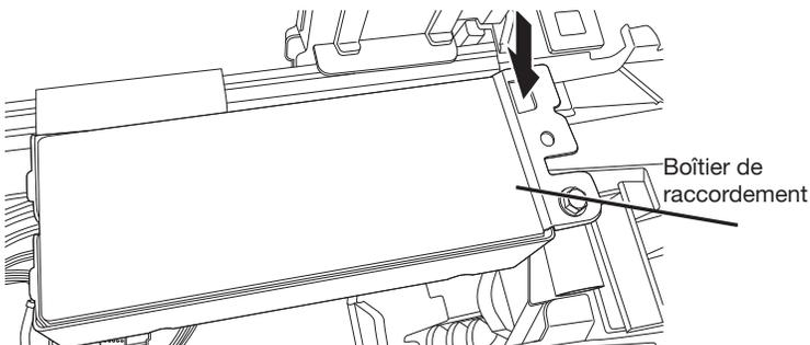
Pour retirer le boîtier de raccordement, appuyer sur le fermoir en plastique, glisser la boîte vers la gauche de l'appareil contre le tube de métal et faire tourner le côté gauche de la boîte vers l'avant. S'assurer que le câblage du produit reste attaché dans le boîtier de raccordement.
