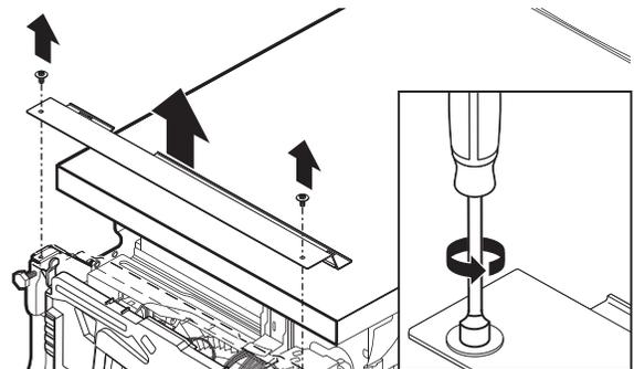
À l'aide d'un tourne-écrou de 5/16 po (7,9 mm), ôter les deux vis fixant les panneaux d'accès au lave-vaisselle. Après avoir enlevé les vis, pousser le panneau d'accès vers le haut du projet pour le déverrouiller, puis l'enlever.
