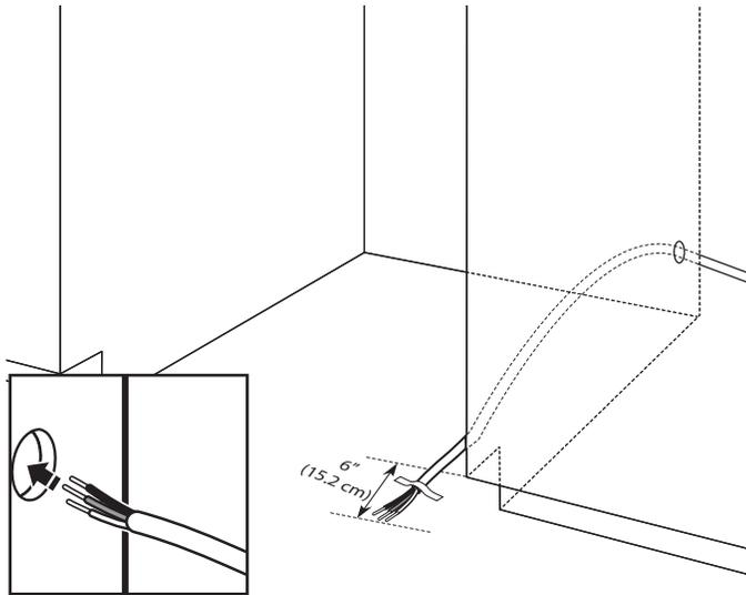
Passer le câble comme indiqué pour un raccordement direct. Ne pas brancher pour l'instant le câble au produit. Ce branchement sera effectué plus tard, une fois que l'appareil sera installé dans l'ouverture de l'armoire.
