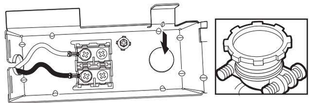
Installer un serre-câbles métallique (homologation UL/CSA). S'assurer que les têtes de vis soient orientées vers le haut lors du serrage de l'écrou à conduit. Un serre-câbles est fourni dans l'ensemble du cordon d'alimentation.
