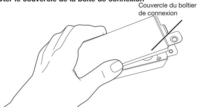
À l'aide d'un tourne-écrou de 1/4 po (6,4 mm), retirer la vis fixant le couvercle du boîtier de raccordement. Retirer le couvercle en le soulevant du boîtier. Conserver le couvercle pour utilisation ultérieure.
