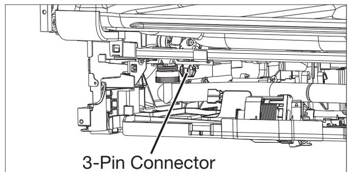
Sur certains modèles, un câble de connexion de service avec connecteur à 3 broches est laissé volontairement débranché et rangé derrière le panneau d'accès. Ce câble est à l'usage du technicien d'entretien.
