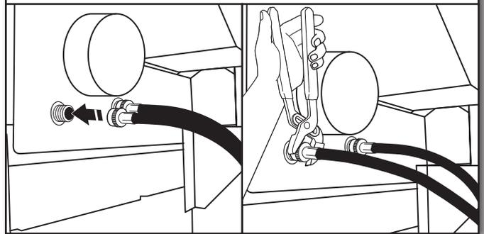
Sujete la manguera de agua caliente a la válvula de entrada derecha (roja). Atornille el acoplamiento a mano hasta que quede apretado. Use pinzas para apretar los acoplamientos dos tercios de vuelta adicional. Repítalo con la válvula de entrada del agua fría (válvula de entrada izquierda [azul]).
