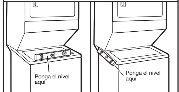
Con la lavadora/secadora en su ubicación final, coloque un nivel en los bordes superiores de la misma. Use la hendidura lateral como una guía para revise la nivelación de los lados. Revise la nivelación del frente usando la tapa, como se muestra. Balancee la lavadora/secadora hacia delante y hacia atrás para asegurarse de que las cuatro patas hagan contacto firme con el piso. Si la lavadora/secadora está nivelada, saltee al "Instale los soportes antivuelco."
