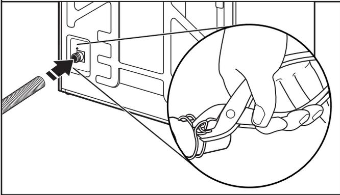
Abra la abrazadera. Tuerza la manguera hacia atrás y hacia adelante mientras empuja sobre el conector de desagüe en la parte inferior izquierda de la parte posterior de la lavadora/secadora. Continúe hasta que la manguera entre en contacto con los topes estriados sobre la carcasa. Coloque la abrazadera sobre el área que tiene la marca "CLAMP" (abrazadera). Suelte la abrazadera.
