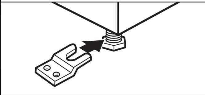
**Para usar en casas rodantes:** Las lavadoras/secadoras con secadoras a gas deben estar ajustadas firmemente al piso.
