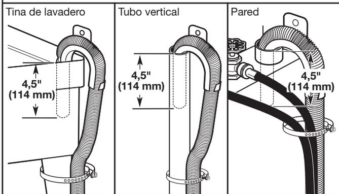
Asegure la manguera de desagüe a la pata del lavadero, al tubo vertical o a las mangueras de entrada para el tubo vertical de pared, utilizando el fleje de plástico incluido en el paquete de piezas.
