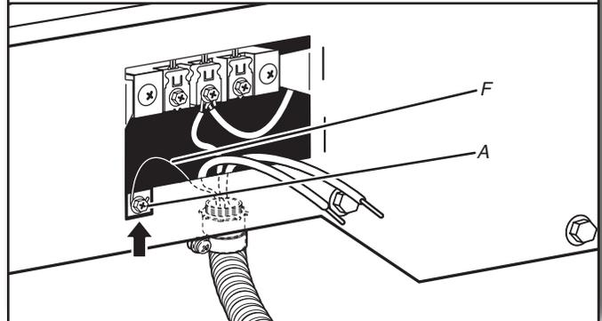
Conecte el hilo de puesta a tierra (verde o desnudo) (F) del cable directo al tornillo conductor a tierra externo (A). Apriete el tornillo.
