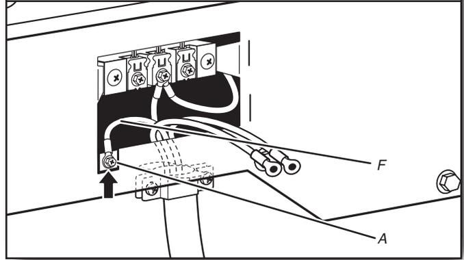
Conecte el hilo de puesta a tierra (F) (verde o desnudo) del cable de suministro de energía al tornillo conductor a tierra externo (A). Apriete el tornillo.
