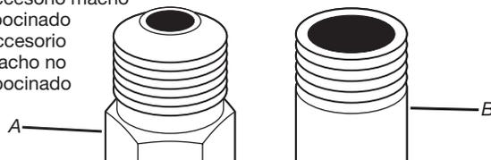
Quite la tapa roja del conector de gas flexible. Quite el adaptador NPT de 1/2" del conector de gas flexible (será necesario usar dos llaves de tuerca ajustables). Use compuesto para unión de tubos en las roscas de todos los accesorios macho no abocinados. Si se usa tubería flexible de metal, asegúrese de que no hayan partes retorcidas.
