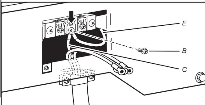
Conecte el hilo neutro de puesta a tierra (E) y el hilo neutro (hilo blanco o central) (C) del cable de suministro de energía debajo del tornillo central del bloque de terminal (B). Apriete el tornillo.
