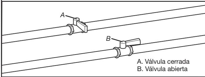
Abra la válvula de cierre en la línea de suministro; la válvula está abierta cuando la manija está paralela al tubo de gas. Luego pruebe todas las conexiones aplicando con un cepillo una solución aprobada para detección de fugas que no sea corrosiva. Se observarán burbujas si hay fugas. Tape cualquier fuga que encuentre.
