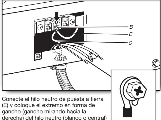
Conecte el hilo neutro de puesta a tierra (E) y coloque el extremo en forma de gancho (gancho mirando hacia la derecha) del hilo neutro (blanco o central) (C) del cable de conexión directa debajo del tornillo central del bloque de terminal (B). Apriete los extremos en forma de gancho y apriete el tornillo.
