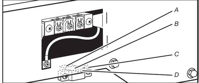
Quite los tornillos de un protector de cables de 3/4" (19 mm) que esté en la lista de UL. Coloque las lengüetas de las dos secciones de la abrazadera (C) en el orificio que está debajo de la abertura del bloque de terminal (B) de manera que una lengüeta esté apuntando hacia arriba (A) y la otra esté apuntando hacia abajo (D), y sujételas en su lugar. Apriete los tornillos del protector de cables sólo lo suficiente para mantener las dos secciones de la abrazadera (C) juntas.
