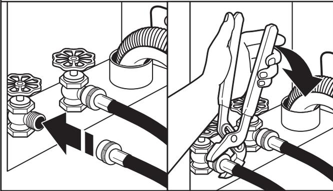
Sujete una manguera al grifo de agua caliente. Atornille el acoplamiento con la mano hasta que se asiente en la arandela. Usando las pinzas, apriete los acoplamientos dos tercios de vuelta adicional. Repita este paso con la segunda manguera para el grifo de agua fría.
