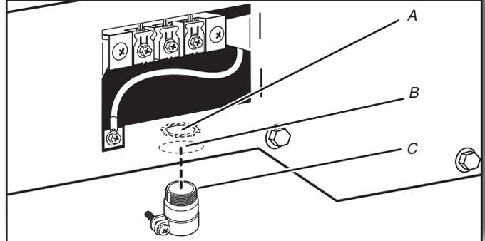
Desatornille el conector de conducto removible (A) y cualquier tornillo del protector de cables de 3/4" (19 mm) que está en la lista de UL. Haga pasar la sección trenzada del protector de cables (C) a través del orificio que está debajo de la abertura del bloque de terminal (B). Busque dentro de la abertura del bloque de terminal y atornille el conector de conducto removible (A) sobre las roscas del protector de cables.
