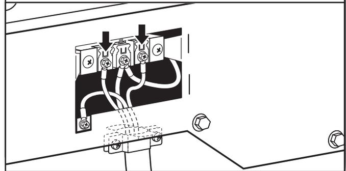
Conecte los hilos restantes a los tornillos externos del bloque de terminal. Apriete los tornillos. Por último vuelva a insertar la lengüeta de la tapa del bloque de terminal dentro de la ranura del panel posterior de la secadora. Asegure la tapa con un tornillo de sujeción. Ahora vaya a "Requisitos de ventilación."
