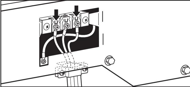
Conecte los hilos restantes a los tornillos externos del bloque de terminal. Apriete los tornillos. Por último vuelva a insertar la lengüeta de la tapa del bloque de terminal dentro de la ranura del panel posterior de la secadora. Asegure la tapa con un tornillo de sujeción. Ahora vaya a "Requisitos de ventilación."
