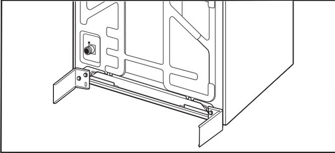
**IMPORTANTE:** Deben instalarse los soportes antivuelco para evitar posibles vuelcos hacia atrás de la lavadora/secadora.
