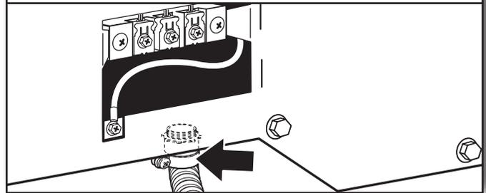
Haga pasar el cable directo a través del protector de cables. El protector de cables deberá encajar de manera ajustada con la carcasa de la secadora y estar en posición horizontal. Apriete el tornillo del protector de cables contra el cable directo.
