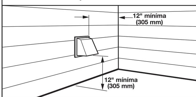
Instale la capota de ventilación. Emplee una masilla de calafateo para sellar la abertura de la pared externa alrededor de la capota de ventilación.
