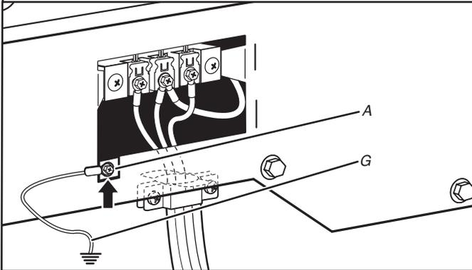
Conecte un hilo a tierra de cobre separado (G) desde el tornillo conductor a tierra externo (A) a una conexión a tierra adecuada. Por último vuelva a insertar la lengüeta de la tapa del bloque de terminal dentro de la ranura del panel posterior de la secadora. Asegure la tapa con un tornillo de sujeción. Ahora vaya a "Requisitos de ventilación."
