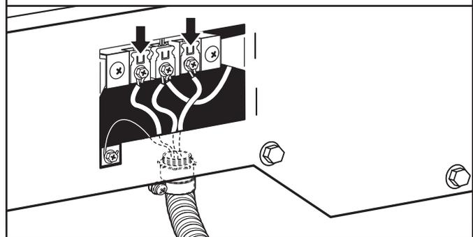
Coloque los extremos en forma de gancho de los hilos restantes del cable de conexión directa debajo de los tornillos exteriores del bloque de terminal (con los ganchos mirando hacia la derecha). Apriete los extremos en forma de gancho y apriete los tornillos. Por último vuelva a insertar la lengüeta de la tapa del bloque de terminal dentro de la ranura del panel posterior de la secadora. Asegure la tapa con un tornillo de sujeción. Ahora vaya a "Requisitos de ventilación."
