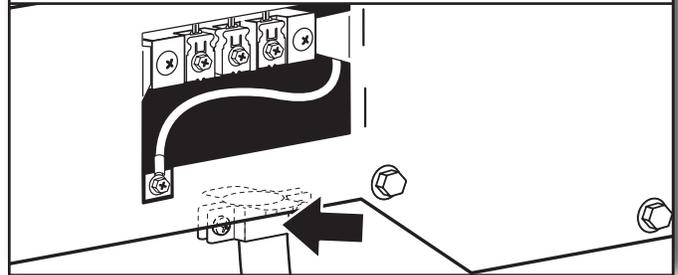
Haga pasar el cable de suministro de energía a través del protector de cables. Asegúrese de que el aislamiento de cables del cable de suministro de energía esté dentro del protector de cables. El protector de cables deberá encajar de manera ajustada con la carcasa de la secadora y estar en posición horizontal. No ajuste más los tornillos del protector de cables en este momento.
