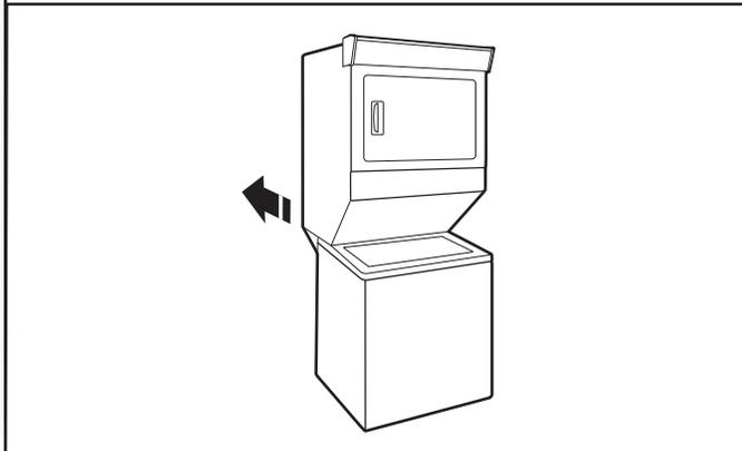
Traslade la lavadora/secadora hacia su ubicación final, teniendo cuidado de no aplastar ni torcer el ducto de escape.
