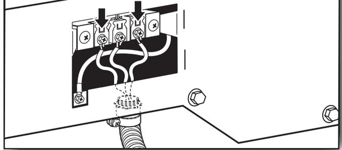
Coloque los extremos en forma de gancho de los hilos restantes del cable de conexión directa debajo de los tornillos exteriores del bloque de terminal (con los ganchos mirando hacia la derecha). Apriete los extremos en forma de gancho y apriete los tornillos. Por último vuelva a insertar la lengüeta de la tapa del bloque de terminal dentro de la ranura del panel posterior de la secadora. Asegure la tapa con un tornillo de sujeción. Ahora vaya a "Requisitos de ventilación."
