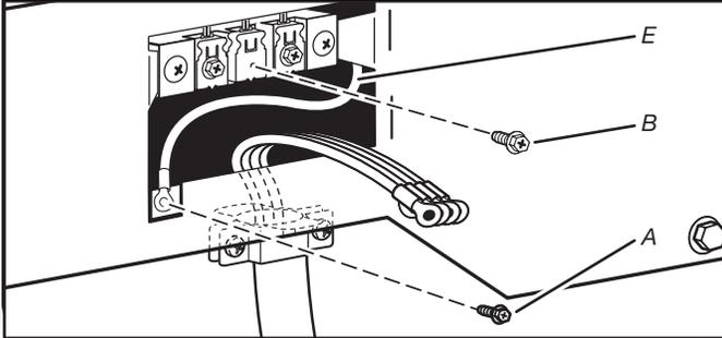
Quite el tornillo central del bloque de terminal (B). Saque el hilo neutro de puesta a tierra (E) del tornillo conductor a tierra externo (A).
