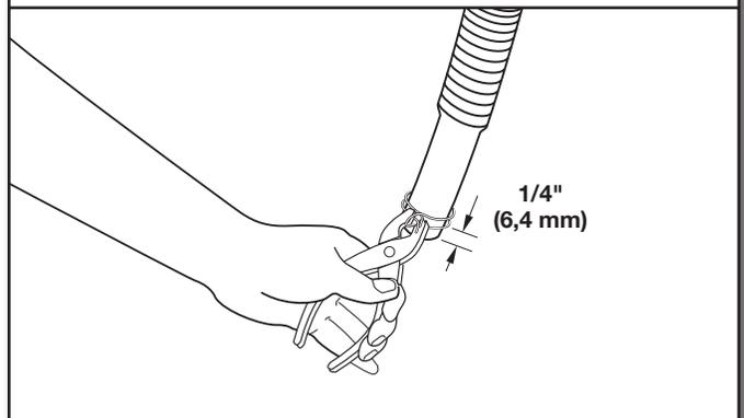
Revise la manguera de desagüe para aver si tiene el largo adecuado. Moje el interior del extremo recto de la manguera de desagüe con agua del grifo.
