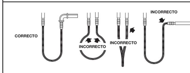
Sujete el conector de gas flexible al adaptador NPT de 1/2". No use compuesto para unión de tuberías para esta conexión. Deberá haber una vuelta natural en el conector de gas flexible. El conector de gas flexible no debe ser retorcido, doblado ni unido con recodos agudos.
