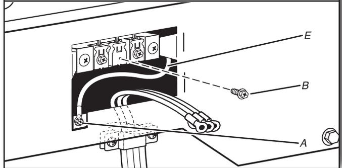
Quite el tornillo central del bloque de terminal (B). Saque el hilo neutro de puesta a tierra (E) del tornillo conductor a tierra externo (A).
