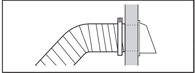
El ducto de escape debe encajar dentro de la capota de ventilación. Asegure el ducto de escape a la capota de ventilación con una abrazadera de 4" (102 mm). Extienda el ducto de escape a la ubicación de la secadora. Use la trayectoria más recta posible. Evite giros de 90°. Use abrazaderas para sellar todas las juntas. No use cinta adhesiva para conductos, tornillos ni otros dispositivos de fijación que se extiendan dentro del ducto de escape para fijarlo, los cuales podrían atrapar pelusa.
