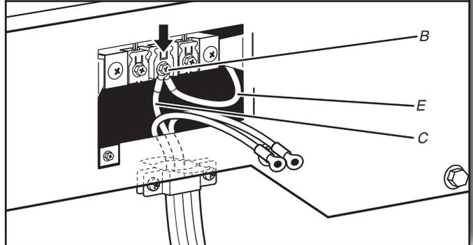
Conecte el hilo neutro de puesta a tierra (E) y el hilo neutro (hilo blanco o central) (C) del cable de suministro de energía o cable directo debajo del tornillo central del bloque de terminal (B). Apriete el tornillo.
