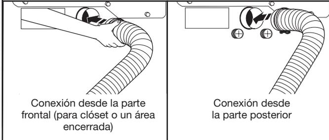
Usando una abrazadera de 4" (102 mm), conecte el ducto de escape a la salida de aire en la secadora. Si se conecta a un ducto de escape existente, asegúrese de que el mismo esté limpio. El ducto de escape de la secadora debe encajar sobre la salida de aire de la secadora y dentro de la capota de ventilación. Cerciórese de que el ducto de escape esté asegurado a la capota de ventilación con una abrazadera de 4" (102 mm).
