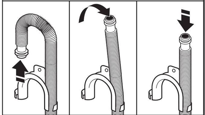
Para las instalaciones con desagüe por el piso, necesitará quitar el molde de la manguera de desagüe del extremo de la misma. Puede ser que necesite piezas adicionales con instrucciones por separado. Vea "Herramientas y piezas."
