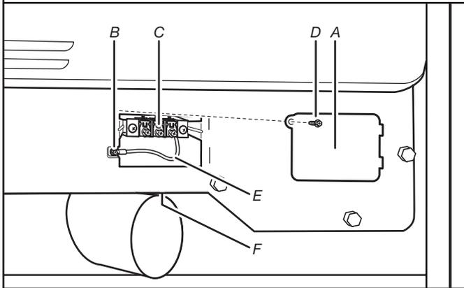
Desconecte el suministro de energía antes de comenzar. Quite el tornillo de sujeción (D) y la tapa del bloque de terminal (A).
