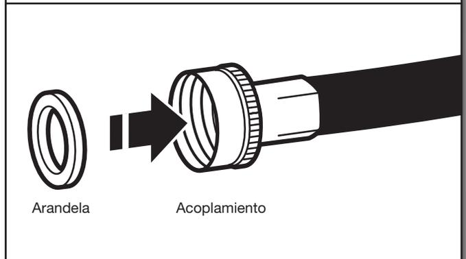
Inserte las nuevas arandelas para manguera (no suministradas) en cada extremo de las mangueras de entrada. Asiente firmemente las arandelas en los acoplamientos.
