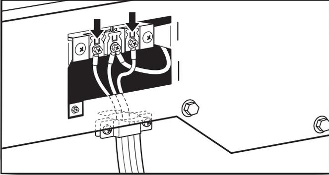
Coloque los hilos restantes debajo de los tornillos exteriores del bloque de terminal (con los ganchos mirando hacia la derecha). Apriete los tornillos.
