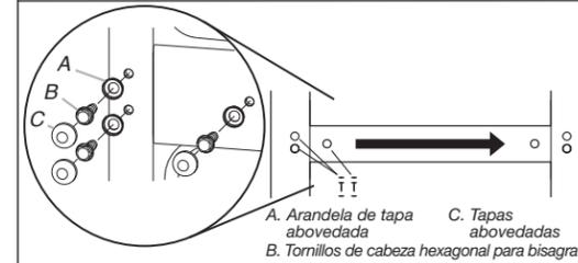
**2.** En algunos modelos con base de plástico, incline la unidad hasta que se pueda quitar la bisagra (Opcional: retire ambas bases de plástico). Mueva la bisagra inferior y calce al lado opuesto del gabinete. **IMPORTANTE:** Asegúrese de que la arandela permanezca en el pasador de la bisagra y coloque la cuña de plástico o metálica en la misma posición entre el gabinete y la bisagra y devuelva el producto a la posición estándar. **NOTA:** El estilo de las bisagras variará según el modelo.
