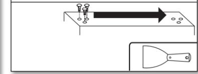
**2.** Coloque la puerta del congelador en la bisagra central. No olvide instalar la arandela en el pasador de bisagra central.
