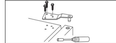
**2.** Retire la cinta de la puerta del gabinete y levante la puerta del congelador del pasador de la bisagra central. **IMPORTANTE:** Coloque la puerta sobre una superficie suave para evitar abolladuras y rayones.
