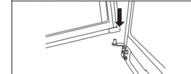
**4.** Apriete los tornillos (previamente aflojados) y vuelva a instalar y apriete el tornillo de la bisagra central. **IMPORTANTE:** Asegúrese de que las arandelas se encuentren en los pasadores superiores e inferiores del centro de la bisagra. Asegúrese de que quede una cuña de plástico entre el gabinete y la bisagra central en algunos modelos.
