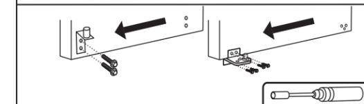
**3.** Coloque el refrigerador sobre el pasador de la bisagra inferior.
