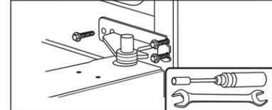
**6.** Levante la puerta del refrigerador para retirarla de la bisagra inferior. **IMPORTANTE:** Coloque la puerta sobre una superficie suave para evitar abolladuras y rayones. **NOTA:** El estilo de las bisagras variará según el modelo.
