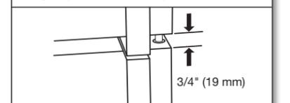
**2.** Apriete completamente los 3 tornillos de la bisagra superior. Secuencia de tornillos: Tornillo 1 hasta la mitad. Tornillo 2 Totalmente asentado. Tornillo 3 Totalmente asentado. Tornillo completo 1.
