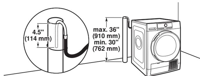
Diamètre minimal pour un tuyau de rejet à l'égout : 2'' (51 mm). Le tuyau vertical de rejet à l'égout doit avoir une hauteur d'au moins 30'' (762 mm); ne pas l'installer à une hauteur supérieure à 36'' (910 mm) du bas de la sècheuse.
